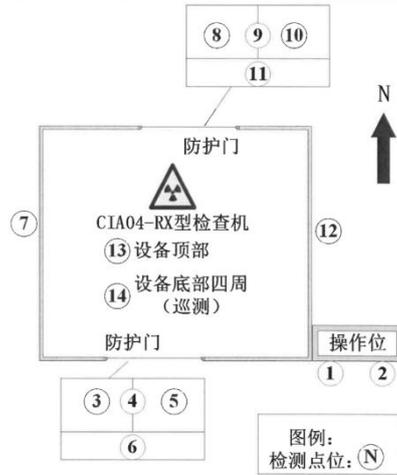
图17 CIA04-RX型X射线装置检测点位示意图
