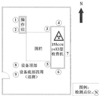
图8 1#AccureX3型X射线装置检测点位示意图
