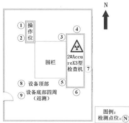
图9 2#AccureX3型X射线装置检测点位示意图
